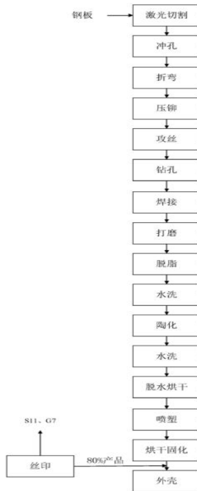
图 2 光缆交接箱工艺流程图
