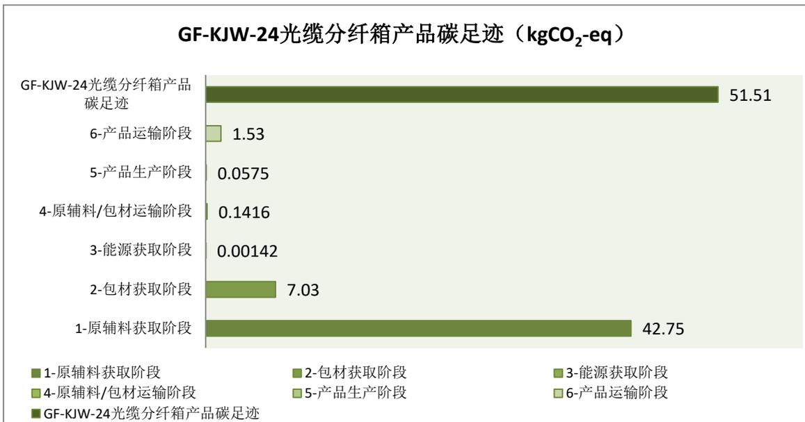
图 10 GF-KJW-24 光缆分纤箱产品生命周期总图
